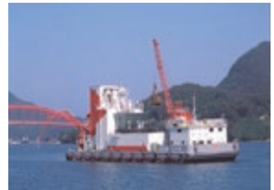
(コンクリートプラント船)
