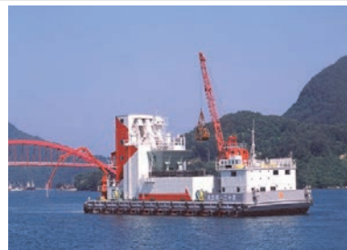
(コンクリートプラント船)
